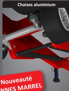
Chaises aluminium qui intègrent les mains de suspension et permettent une fixation optimale des vérins sous caisse
