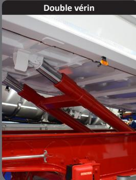
Deux vérins positionnés sous la caisse offrant une rapidité et une stabilité au bannage !
