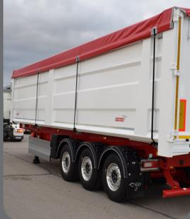
Haute résistance aux chocs et à l'abrasion avec rive supérieure intégrée dans la face latérale
