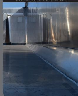
Profilo inferiore di collegamento pareti-fondo stonato per facilitare lo scarico del materiale.
