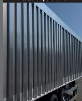
Forma trapezoidale della cassa per ottimizzarne il volume e facilitare le operazioni di scarico.
