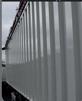
Costolatura raddoppiata nella parte posteriore delle pareti laterale per aumentare la rigidità della struttura
