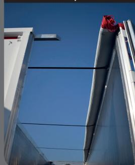
Apertura porta posteriore senza traversa per ottimizzare le operazioni di scarico
