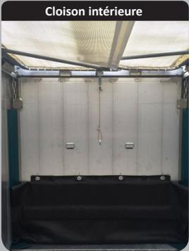
Cloison intérieure mobile renforcée (ép. 6mm) avec bâche renforcement
