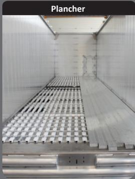
Plancher lisse ou strié en épaisseur en 6,8 ou 10mm. Avec guidage sur ossature tubulaire et patins Teflon
