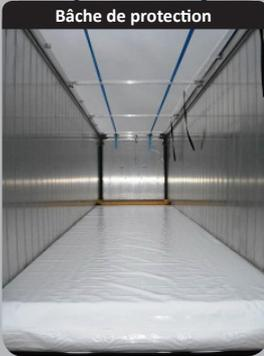
Bâche de protection de fond (avec enrouleur pneumatique ou manuel) pour le transport de conditionnements fragiles, abrasifs, ou très fins.
