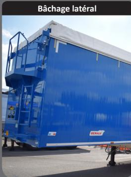
Bâchage latéral manuel ou électrique (EASY TARP) avec passerelle d'accès sur face avant.
