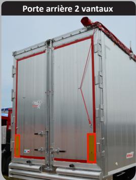
Porte double vantaux semi-encastree (2 crémones). Soudures en continu et butoir transversal continu sur caisson pour la mise à quai
