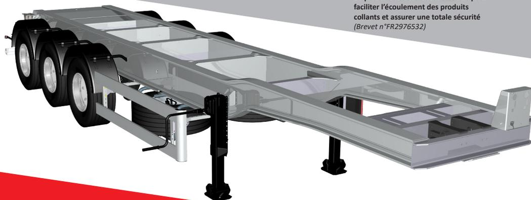
Châssis décroché 100% aluminium
