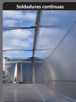
Un proceso de soldadura continua que garantiza una estanqueidad perfecta al nivel de ensamblajes.
