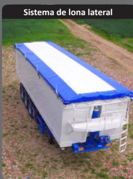
Sistema de lona lateral, fijación por cintas en todos tipos de puertas
