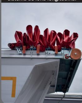
Sistema de lona longitudinal corredero con cables - Mando manual o eléctrico
