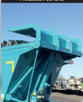
Cubierta de protección de lona de aluminio adaptada a los riesgos de la construcción.
