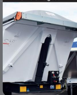
Cilindro de ojo firmemente asegurado que garantiza una robustez adaptada a la industria de la construcción!
