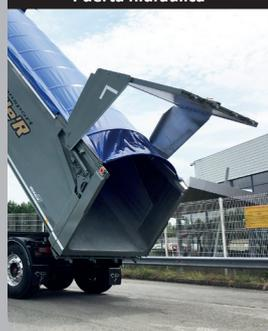
Puerta hidráulica de simple o doble efecto con apertura de gran angular.
