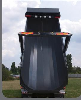
Benne ronde pour châssis 3 ou 4 essieux en version 2 ou 3 tôles.
