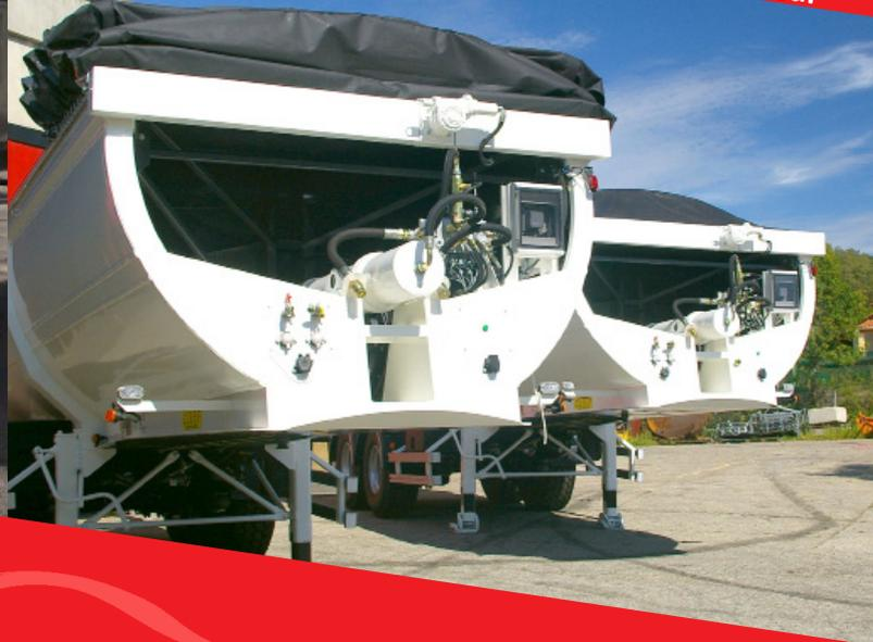
Type : Benne à extraction horizontale
